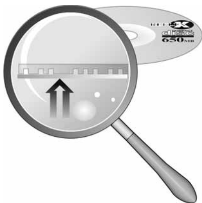
Рис. 10.13. Двоичные состояния поверхности лазерного диска
