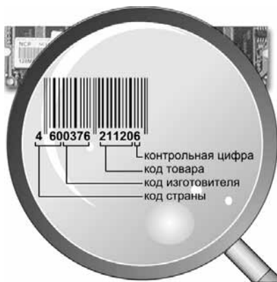
Рис. 10.4. Кодирование при помощи штрих-кода
