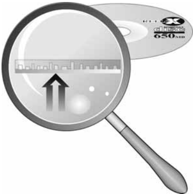
Рис. 4.14. Хранение информации в виде углублений на поверхности лазерного диска
